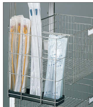
> Carquois à sondes réf 2 258 16 18 Pour le stockage et la mise à disposition des sondes. Acier inoxydable 18/10. Dim. hors tout : 345 x 130 x H.400 mm. 3 compartiments. Poids à vide : 0,8 kg. Charge admissible : 5 kg.
