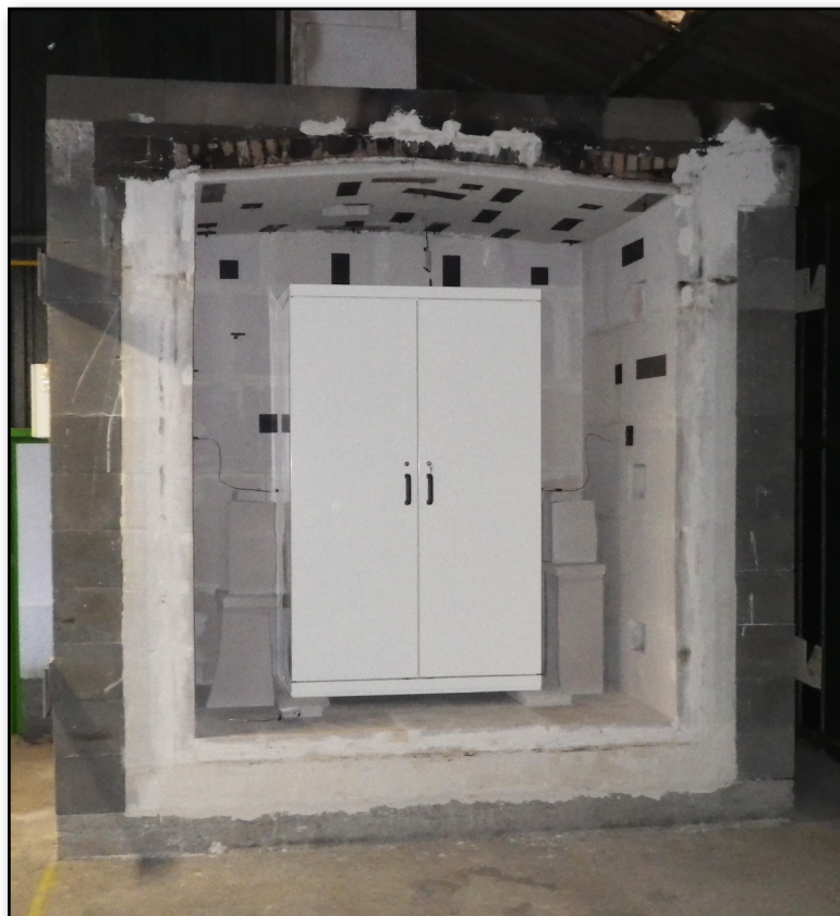
▲ Armoire 795 mise en place dans le four pour test au feu selon la norme EN 14470-1 (photographie avant essai)
