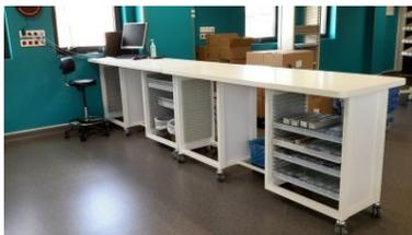
**Le plateau** a une profondeur de 500 à 800 mm, 650 est le plus courant pour une paillasse murale. Les longueurs vont de 1 à 4 m en une ou plusieurs pièces suivant le matériau retenu.
