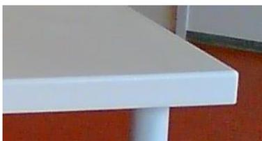
**La résine minérale acrylique** est un support très résistant à l'humidité avec un très bon vieillissement. C'est le matériau à privilégier pour les paillasses humides. L'épaisseur est de 12 mm sur un support Stratifié. Les assemblages sont réalisés par soudage sans joint apparent. Les retombées sur les côtés visibles sont de 50 mm. Elles peuvent permettre de cacher la structure porteuse.
