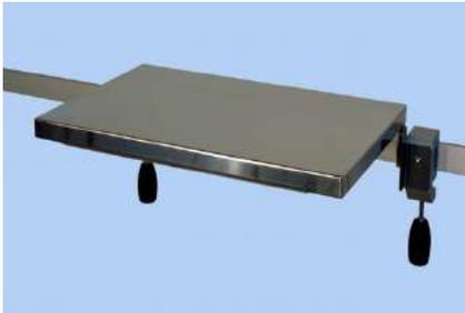
**Réf. 7575** : Console inox 18/10 rabattable sans rebord livrée avec 2 étaux de fixation. Largeur 465 mm, profondeur 300 mm, charge admissible 15 kg
